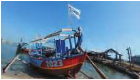
Pengerjaan tahap akhir perahu dengan penambahan mesin, atap, dan pengecatan.
